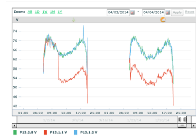
Es ist leicht, den Bypass-Diodenfehler mit den Spannungsbildern auf Modulniveau zu identifizieren. Das defekte Modul gibt nur 2/3 der Spannung aus (in 5/6 der Fälle werden Leistungsoptimierer an 2 Module angeschlossen).
